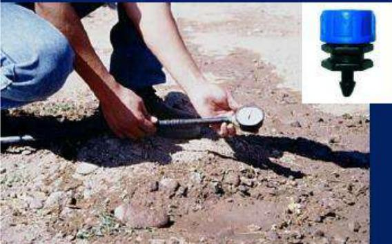
REGULAR PRESIONES EN VÁLVULAS Y MEDIR PRESION EN COLA S MAS EXTREMAS
