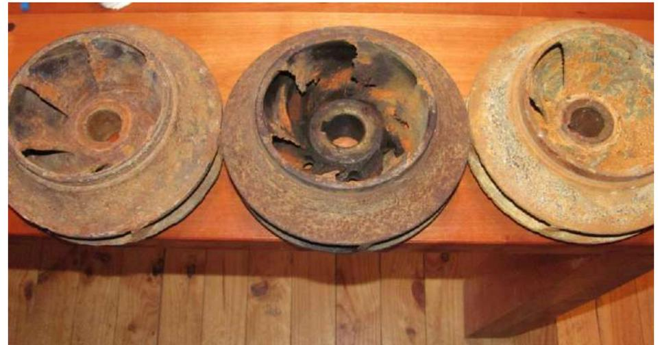
**Rodete de una bomba centrifuga desgastado en forma prematura por el paso de fertilizantes y ácidos.**
