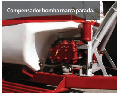
Compensador de presión bomba de membrana. Si al presionar la válvula de aire sale agua es señal de que la membrana del compensador está dañada o ausente.
